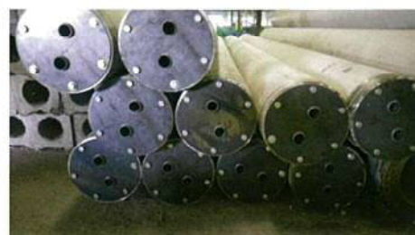
DH 快速基樁 樁頭結構模型
