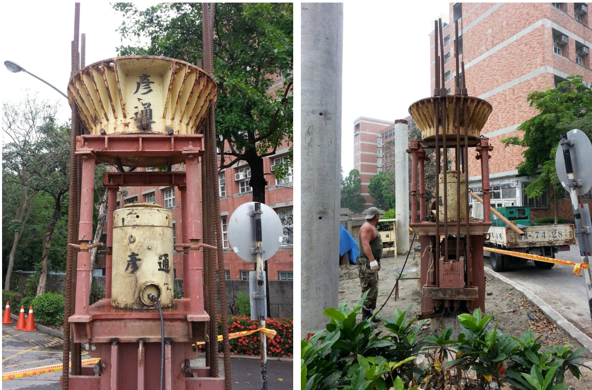
▲圖 1-5: DH 樁拉頭試驗 [1]
