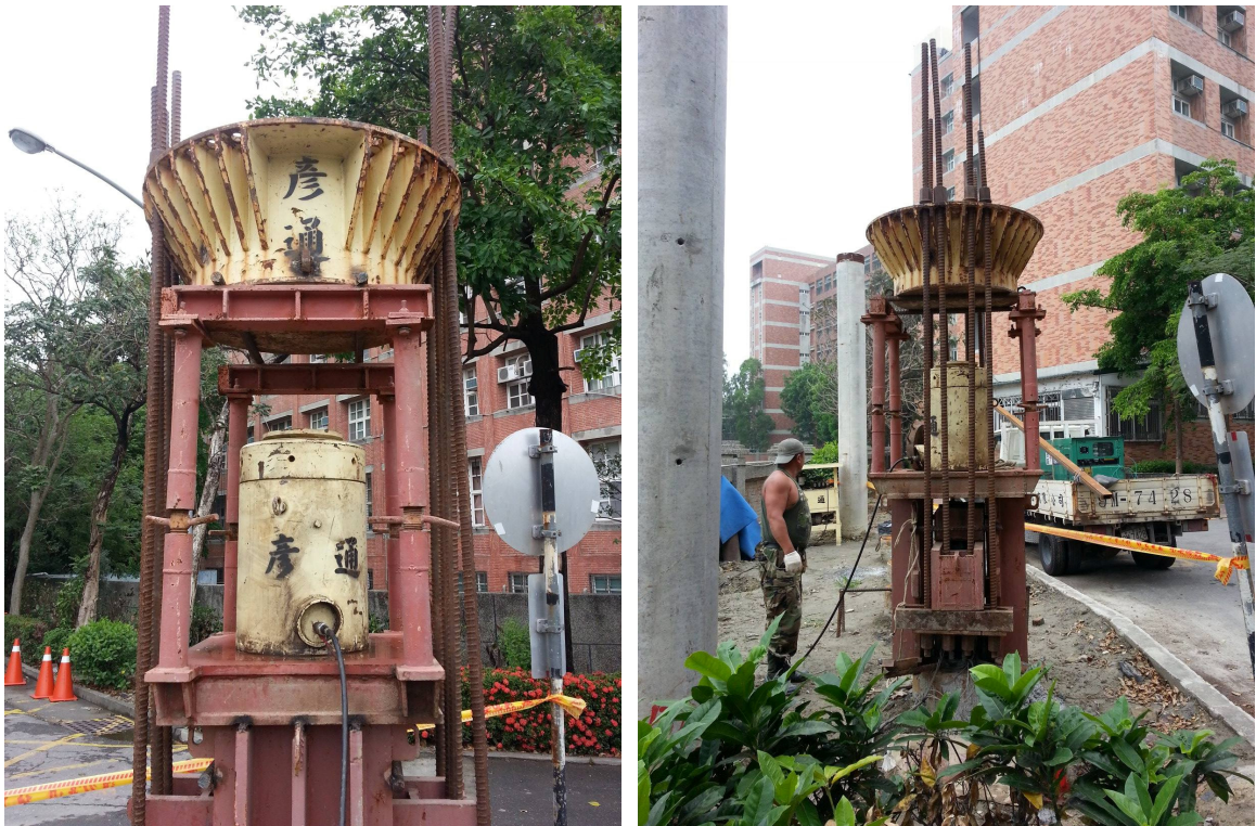
▲图 1-5: DH 桩拉头试验 [1]
