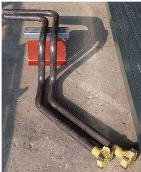
▲圖 2-1：1.25 吋 160s(厚度 6.4t)油壓管線(連續 4 彎管)、ISO 配管圖
