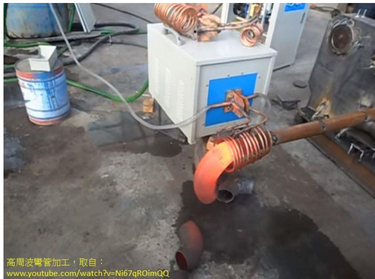
▲圖 1-1：傳統彎頭是在加工廠以高周波加熱彎曲製造 (摘自 Youtube)
