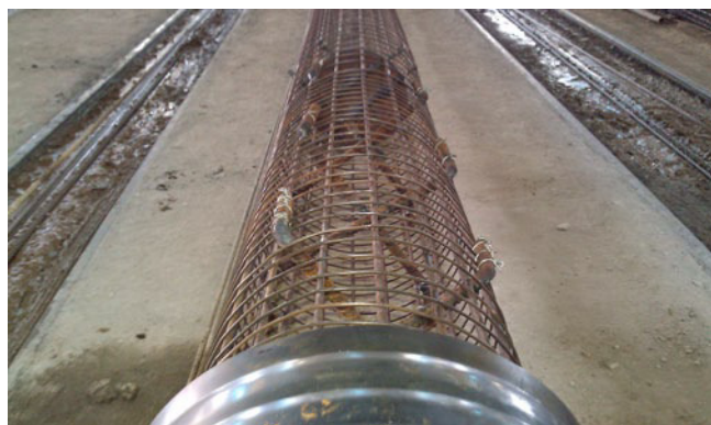
图 4 DH 基桩工厂作业时桩头钢筋笼组立情形 [8]
